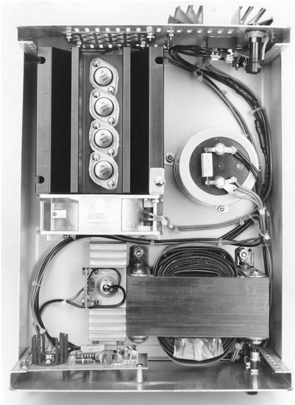
Fig. 11.52 - Interior da fonte de 28 Volts e alta corrente. O ventilador de arrefecimento só é necessário se os transistores de passagem e os dissipadores forem montados dentro do gabinete. Veja o texto.
